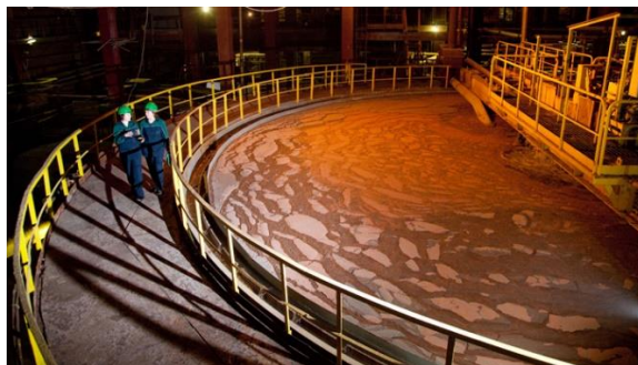
写真 4. 加里鉱石の浮遊選鉱
